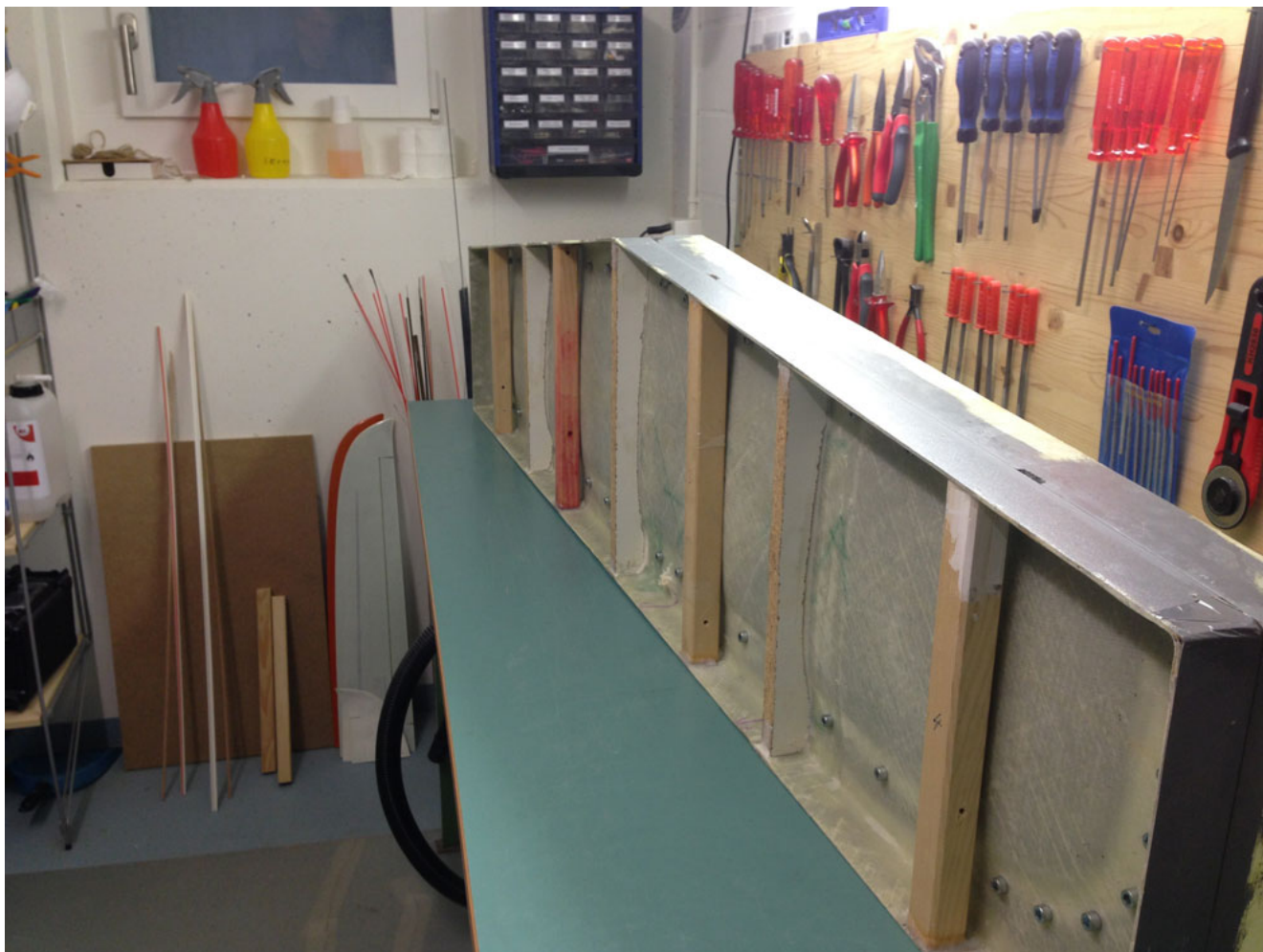
Alles bereit für die Entformung IMG_3537.jpg (116.73 KiB) 2122-mal betrachtet
