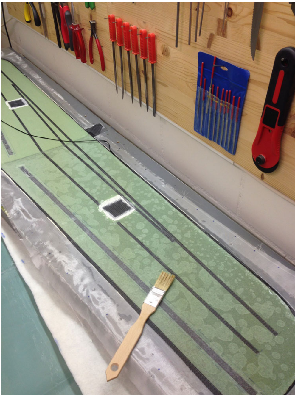
Holmgurten, Bereiche NL und EL mit Rowings versehen IMG_3438.jpg (151.16 KiB) 3981-mal betrachtet
