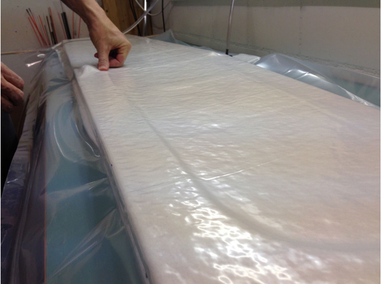
Abreissgewebe, Lochfolie, Haushaltspapier und Bleeder drauf und alles ab in den Sack IMG_3413.jpg (81.29 KiB) 3981-mal betrachtet
